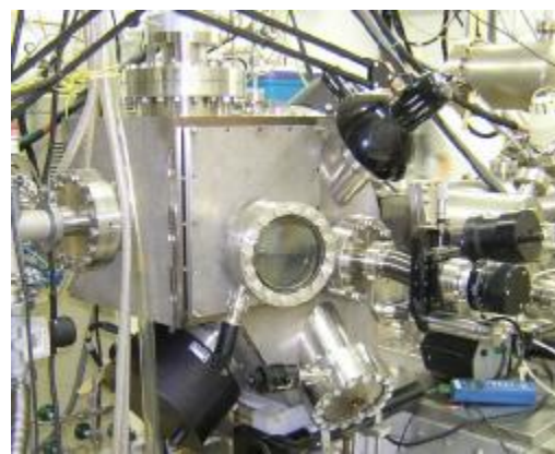
Figura3a. Painel superior: esquema e vista geral do sistema de sputtering assistido por feixe iônico. Painel inferior: vista geral do sistema real.
