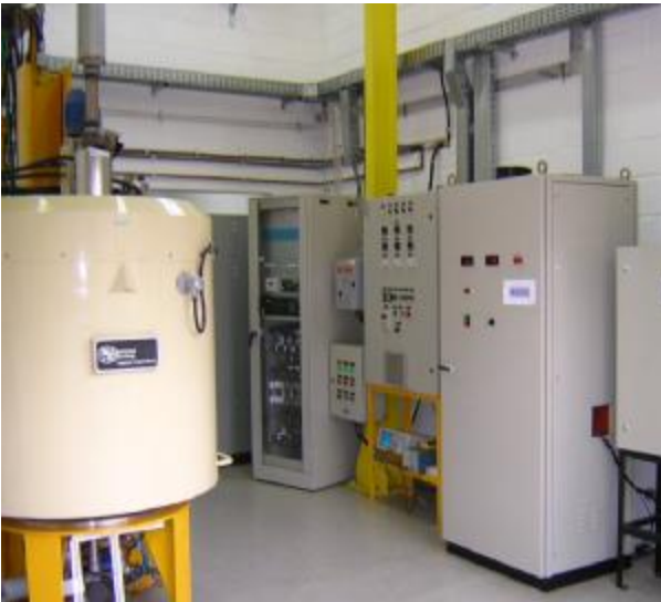
Figura 1: vista geral da planta de nitretação iônica operando no Laboratório LIITS da Unicamp.
