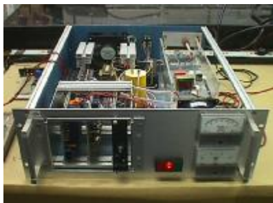
Figura 5a. Vista interior da fonte de alta tensão.
