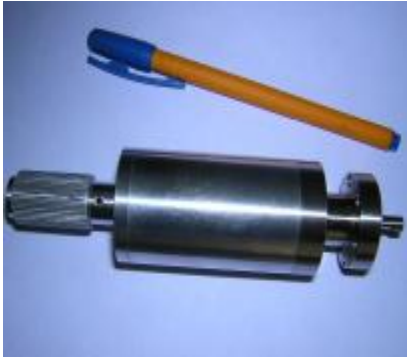
Figure 3b. Passante rotatório para alto vácuo.
