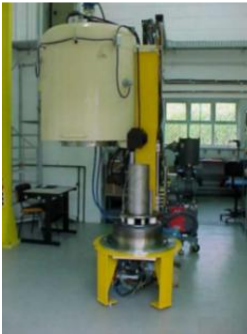
Figure 2. Forno de vácuo de parede aquecida com lifting automático e campânula giratória. Na foto pode-se observar a campânula erguida e rotada.
