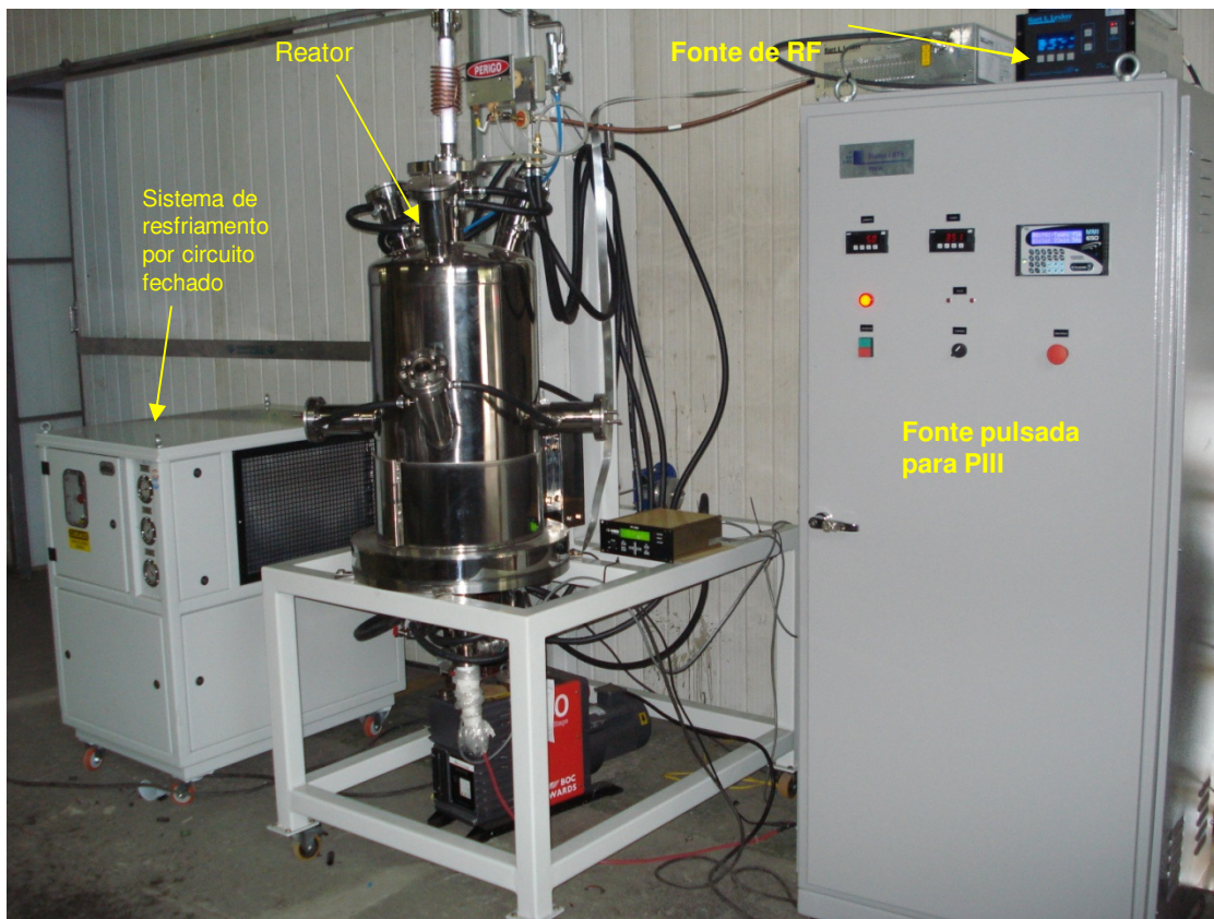
Figura 1. Vista geral da planta de implantação iônica por plasma pulsado (para Plasma Immersion Ion Implantation , PI3) http://youtu.be/gy5dalA16-4
