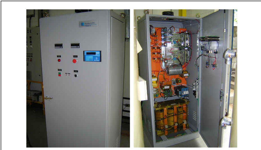
Figura 2. - Vista externa (a esquerda) e interna (a direita) da fonte Plasma-LIITS para processo HiPIMS
